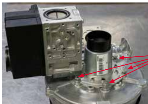
Photon 120 Verbrennungsgebläse entfernen um Gasventil-Befestigungsschrauben freizulegen
