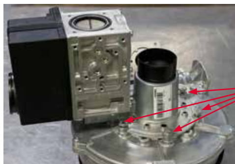
Démontez le ventilateur de combustion du Photon 120 pour faire apparaître les vis de fixation de la vanne de gaz
