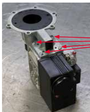
Vis de fixation de la vanne de gaz du Photon 120
