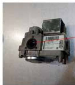
Zespół kołnierza wlotowego zaworu gazowego Photon 10-70
