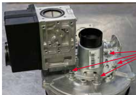
Retirada del ventilador de combustión para revelar los tornillos de fijación de la válvula de gas en Photon 120
