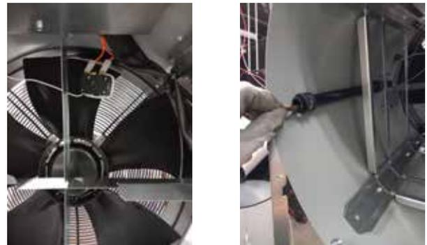
7. Invierta el proceso para sustituir el limitador. Asegúrese de que el limitador se encuentra en la posición correcta, tal y como se indica en el apartado "Ubicación de los sensores y del soporte de los sensores".
