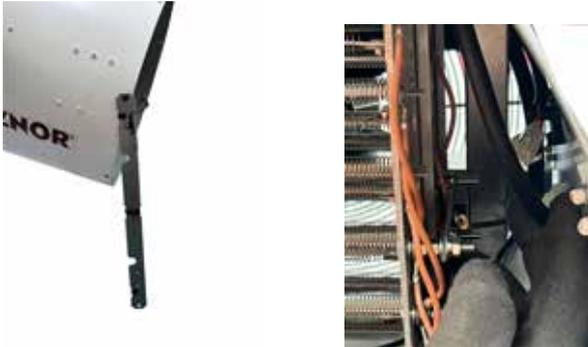
4. Retire los tornillos Torx M6 que sujetan el elemento a la carcasa de la unidad, incluido el cable de toma de tierra.
