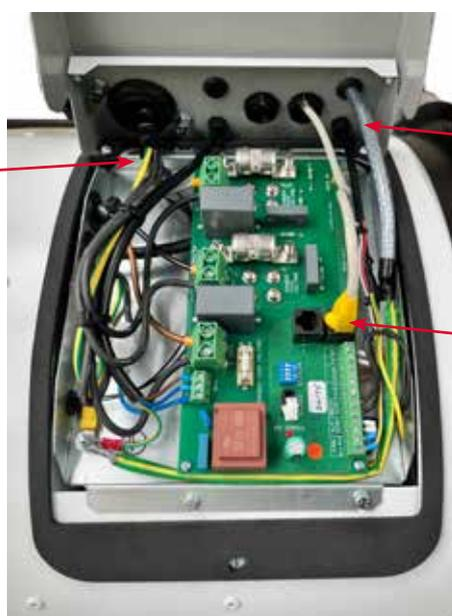
Entrada cable del termostato (máximo 7mm<sup>2</sup>)
