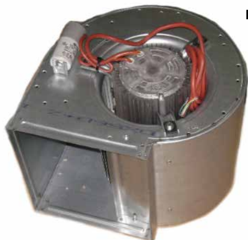
Fig. 9 Toont enkele luchtverdelingsventilator inisolatie voor de duidelijkheid.
