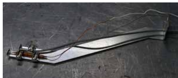
Wspornik montażowy termostatu
