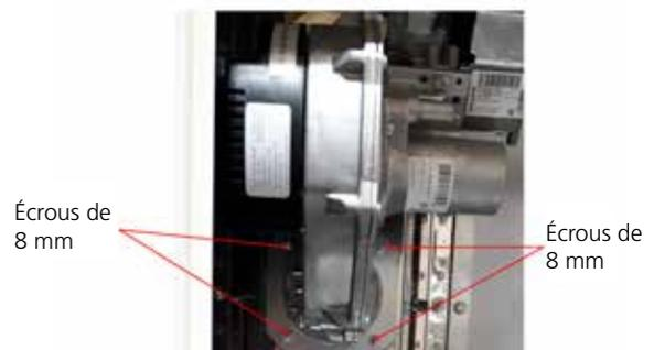
4. Démontez l'ensemble vanne de gaz/ventilateur de combustion de l'appareil.
