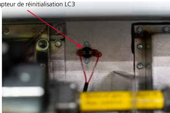
Interrupteur de réinitialisation LC3 Photon 10-20
