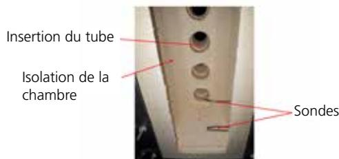
8. Éliminez tous les débris de l'intérieur de la chambre de brûleur. Un vide d'une classe M minimum pour la vitesse d'extraction des poussières peut être utilisé. N'utilisez pas d'air comprimé.
