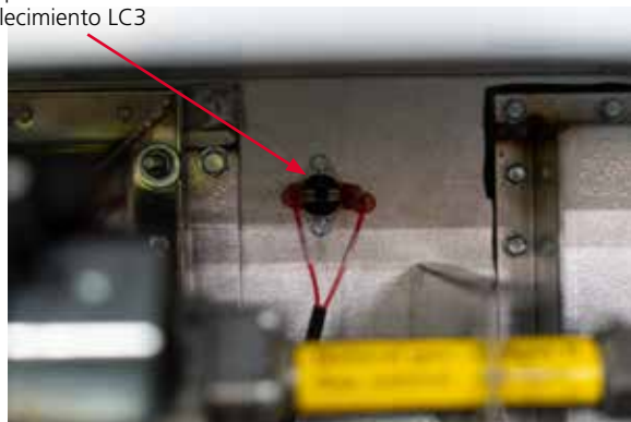
Interruptor de restablecimiento LC3 de Photon 10-20
