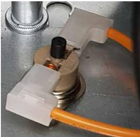
Figura 31 Corte térmico
