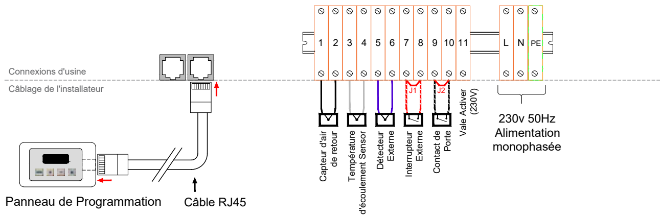
900729 Série Guardian LPHW - Connexions Installateur
