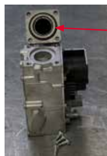
Montage de la bride d'entrée de la vanne de gaz du Photon 100
