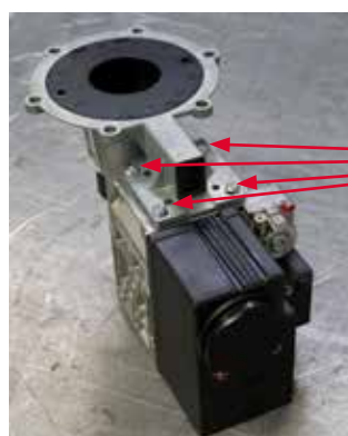
Vis de fixation de la vanne de gaz du Photon 120
