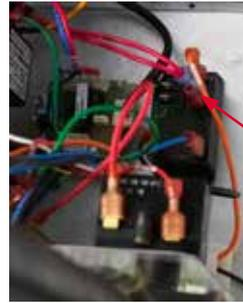
Clavija inactiva, este terminal estará en tensión siempre que el ventilador axial NO esté en funcionamiento, por lo que debe permanecer cubierto.
