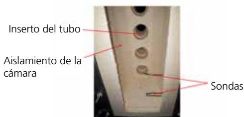
8. Retire cualquier residuo del interior de la cámara de combustión. Se puede emplear una aspiradora con un mínimo de clase M de extracción de polvo. No use aire comprimido.
