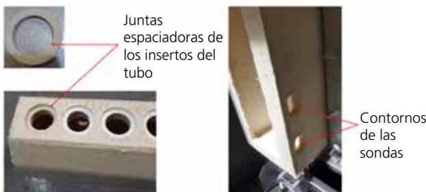
14. Compruebe que los insertos del tubo encajan en el espacio correspondiente en el bloque de aislamiento frontal de la cámara y guíelos con cuidado hacia el aislamiento de la cámara. Asegúrese de que no queda espacio entre el aislamiento de la cámara y los insertos del tubo. Puede que sea necesario insertar hasta tres juntas espaciadoras por cada inserto del tubo.
