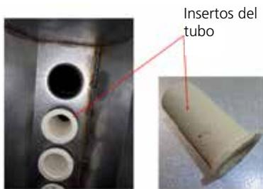
13. Vuelva a colocar los insertos del tubo, las juntas espaciadoras de los insertos y el aislamiento de la cámara con la orientación correcta, de forma que los contornos coincidan con la posición de la sonda del quemador.
