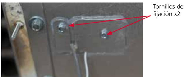
4. Retire el soporte de montaje del generador.
