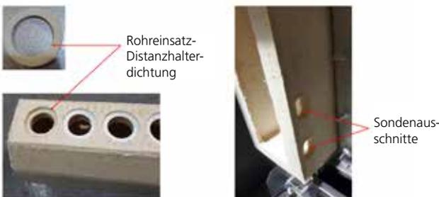
14. Sicherstellen, dass die Rohreinsätze in die entsprechende Aussparung an der Vorderseite des Kammerisolierblockeinrasten. Anschließend vorsichtig in Richtung der Kammerisolierung ziehen. Darauf achten, dass zwischen der Kammerisolierung und den Rohreinsätzen keine Lücken sind. Es können pro Rohreinsatz bis zu drei Rohreinsatz-Distanzhalterdichtungen benötigt werden.
