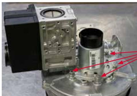
6 Befestigungsschrauben entfernen
