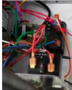
Blindstecker; diese Klemme führt immer dann Strom, wenn der Axiallüfter des Geräts NICHT in Betrieb ist und muss daher abgedeckt sein.
