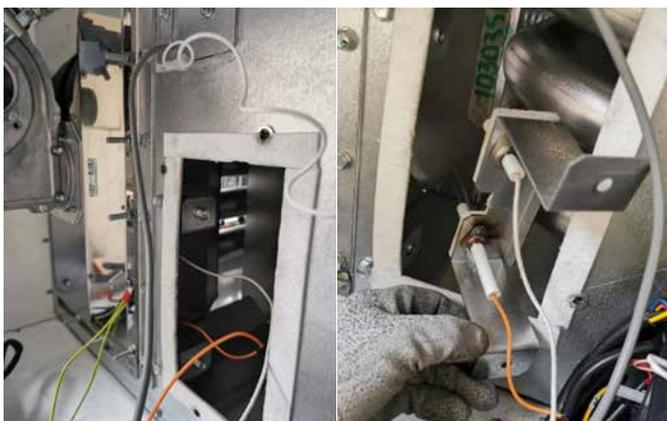
7. Platzieren Sie die beiden Ersatzsondendichtungen aus dem Ersatzsondensatz vorsichtig auf der Halterung der Sondenbaugruppe, bevor Sie sie wieder am Gerät anbringen.
