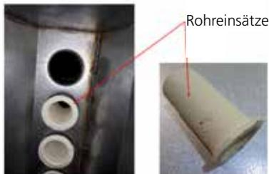
13. Die neuen Rohreinsätze, Rohreinsatz-Distanzhalterdichtungen und Kammerisolierung wieder einbauen und sicherstellen, dass die Kammerisolierung richtig ausgerichtet ist, sodass deren Ausschnitte mit den Positionen der Brennersonden übereinstimmen.
