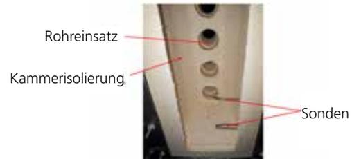
8. Möglicherweise vorhandene Rückstände aus dem Inneren der Brennkammer entfernen. Dazu kann ein Staubsauger mit mindestens der Staubklasse M verwendet werden. Keine Druckluft verwenden!
