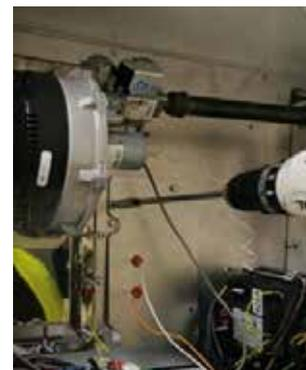
4. Die Sondenbaugruppe ist auf der linken Seite bei abgenommener Zugangsklappe zu sehen.
