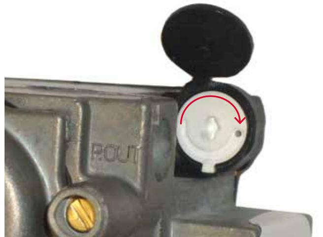
La figure 59. Honeywell VK4105C de la valve à gaz (gaz de réglage d'ouverture lente)
