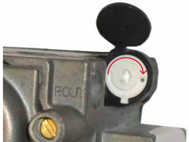
Figuur 59. Honeywell VK4105C Gas Klep (Gasklep langzaam opening afstellen)
