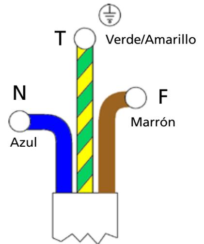
**Ilustración 14.** Cableado monofásico
