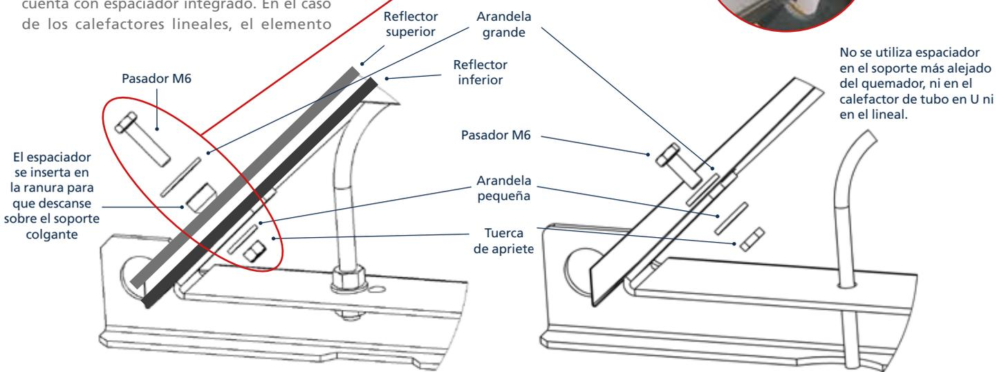
**Ilustración 31.** Reflector en V de tubo en U intermedio
