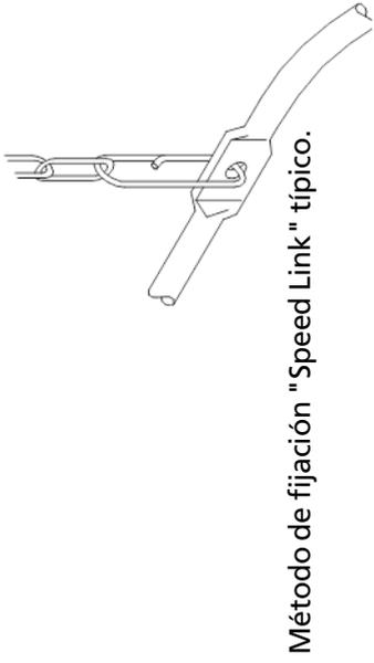
Método de fijación "Speed Link" típico.
