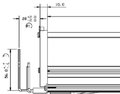
**Ilustración 57.** Detalle del cabezal del quemador
