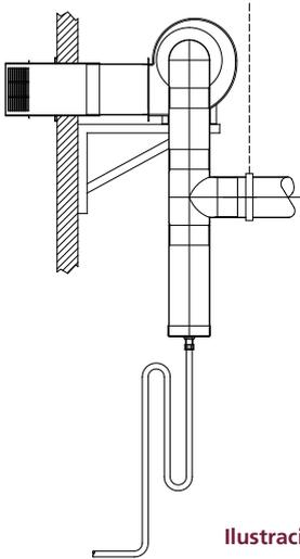
**Ilustración 6.6** Disposición telescópica de acero inoxidable a través de la pared (disponible para ventiladores tipo 'O' y tipo '2')
