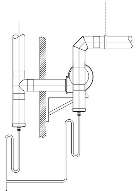
**Ilustración 6.5** Salida de pared para disposición de salida de humos convencional
