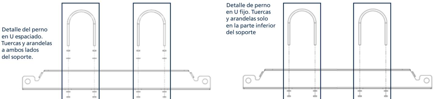
**Ilustración 26.2** Fijación de pernos en U en los soportes de suspensión del calefactor de tubo en U
