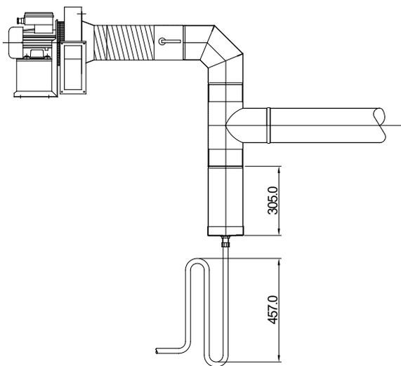
**Ilustración 6.** Disposición de la trampa de condensado
