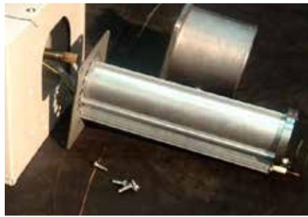
**4.4 Revisión del inyector de gas del quemador**
