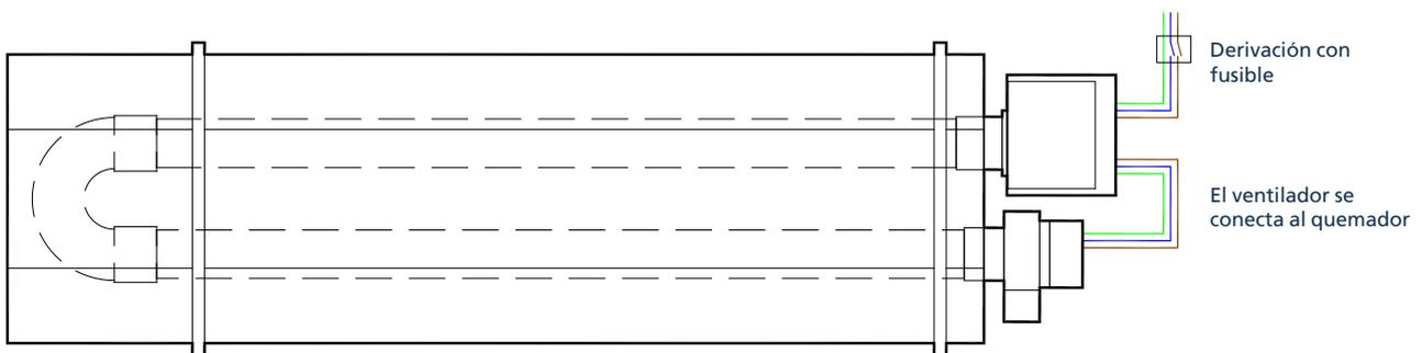
**Ilustración 15.** Conexiones típicas de cableado de VSUTE
