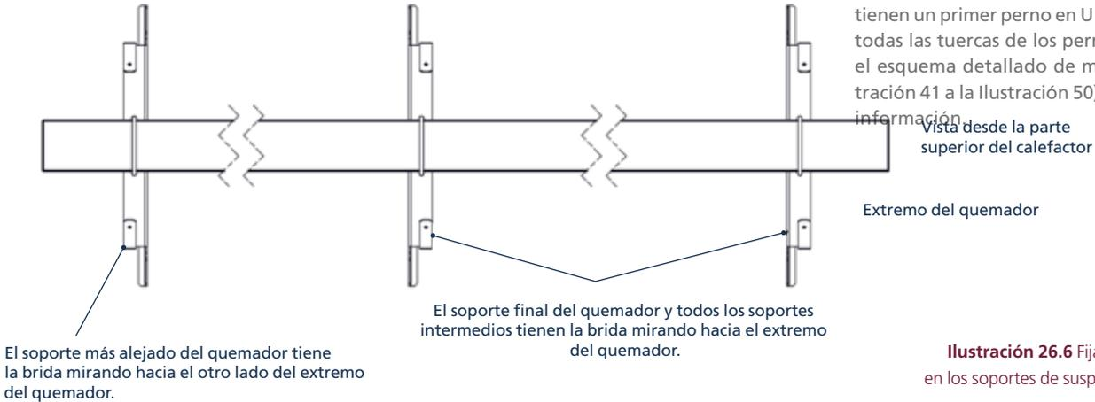
**Ilustración 26.6** Fijación de pernos en U en los soportes de suspensión del calefactor de tubo en U
