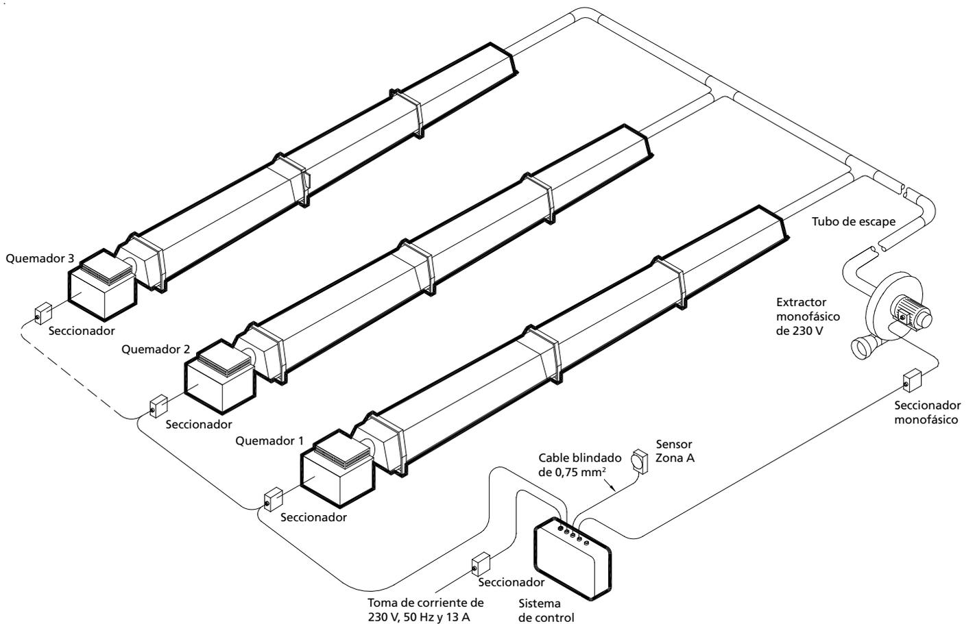
**Ilustración 16.** Conexiones típicas de cableado de VSLHE unitario
