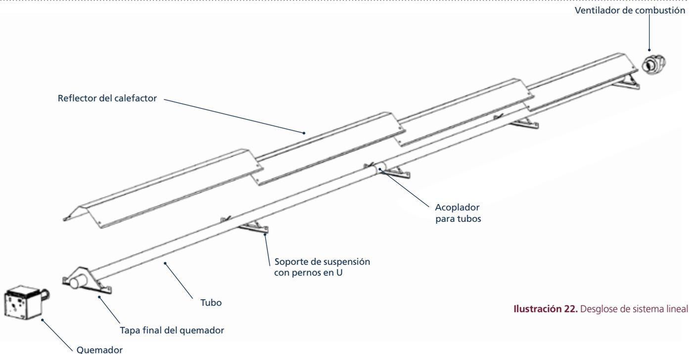
**Ilustración 22.** Desglose de sistema lineal
