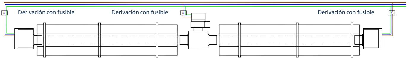
**Ilustración 15.2** Conexiones típicas de cableado de VSDLE unitario
