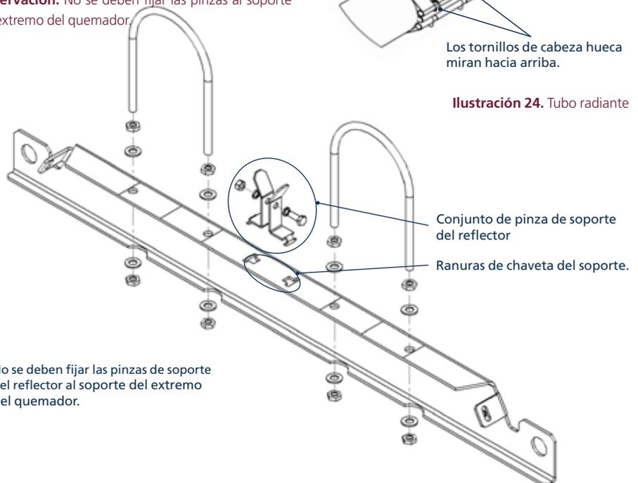
Ilustración 25. Soporte de reflector
