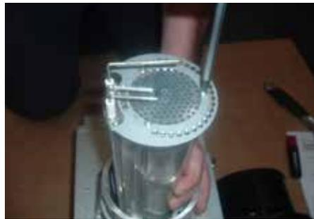
**4.5 Revisión del electrodo y el cabezal del quemador**
