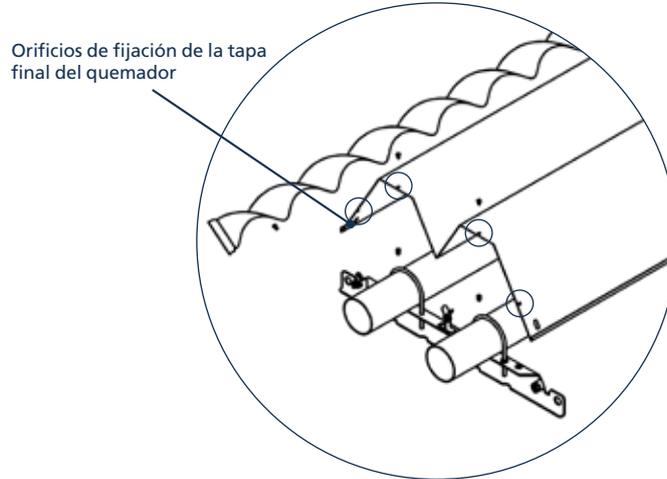
Ilustración 29. Reflector en V de tubo en U final
