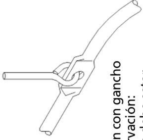
Varilla de suspensión con gancho conformado. Observación: el gancho o armella debe estar completamente cerrado.
