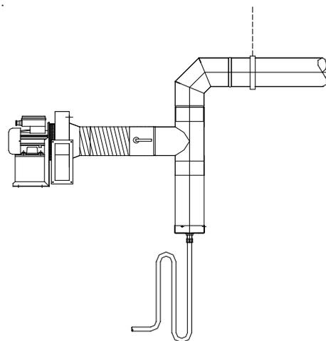
**Ilustración 6.7** Disposición típica de ventilador bajo
