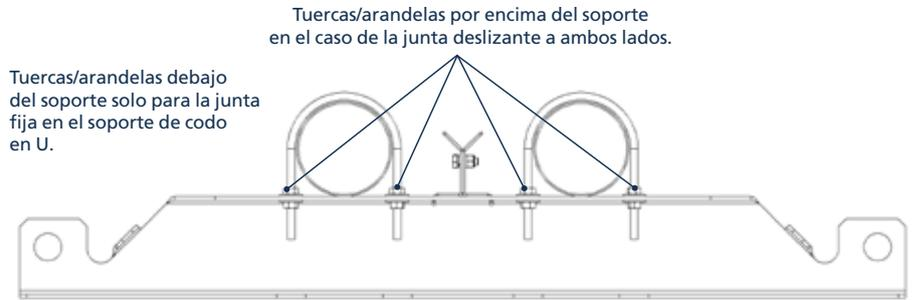
Pernos en U M6 de los soportes restantes de los modelos 15-25 kW y pernos en U M8 de todos los soportes de los modelos de 35-50 kW.
