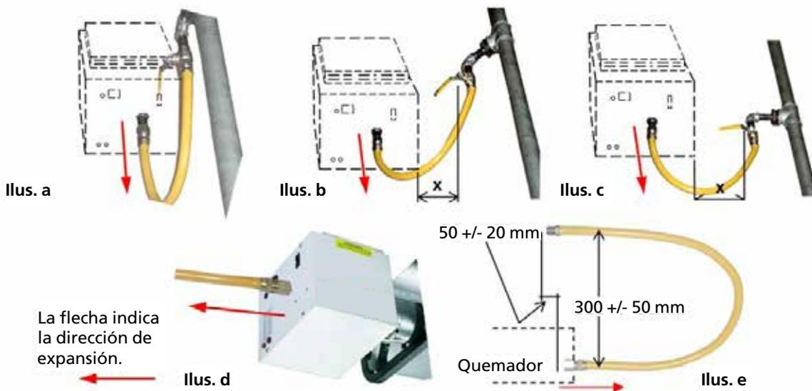
**Ilustración 11.** Instalación correcta del tubo de gas flexible
