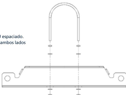
Detalle de perno en U fijo. Tuercas y arandelas en la parte inferior del soporte.
