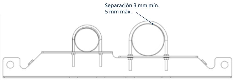
Tuercas/arandelas debajo del soporte solo para la junta fija.
