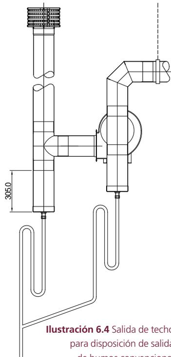
**Ilustración 6.4** Salida de techo para disposición de salida de humos convencional
