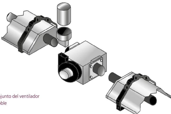
**Ilustración 38.** Conjunto del ventilador del modelo lineal doble
