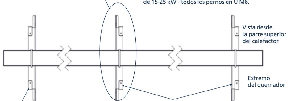
El soporte más alejado del quemador tiene la brida mirando hacia el otro lado del extremo del quemador.
