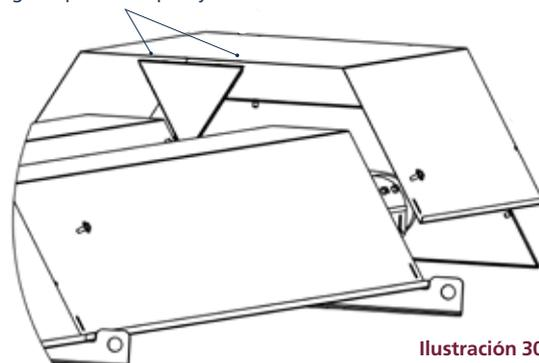
Ilustración 30. Reflector de codo en U
