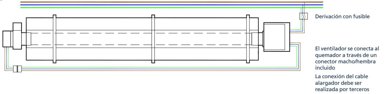
**Ilustración 15.1** Conexiones típicas de cableado de VSLIE
