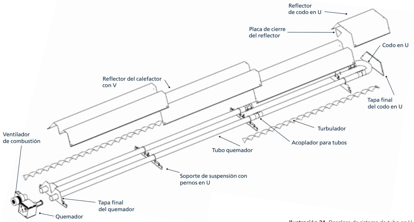
**Ilustración 21.** Desglose de sistema de tubo en U
