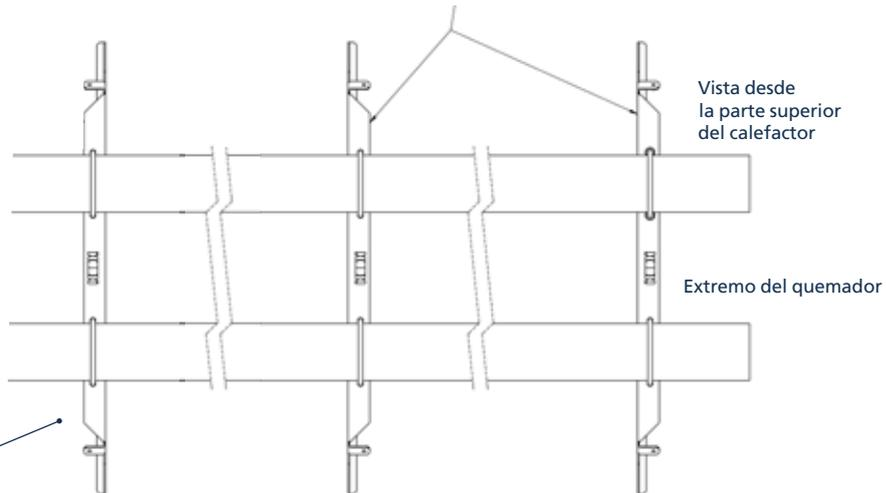
El soporte más alejado del quemador tiene la brida mirando hacia el otro lado del extremo del quemador.
