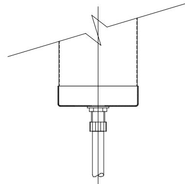
**Ilustración 6.1** Disposición de la trampa colectora de condensado
