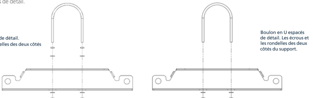
La figure 26.5 Fixer les boulons en U à U-Tube de réchauffage de supports de suspension
