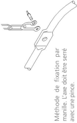
Méthode de fixation par manille. L'axe doit être serré avec une pince.
