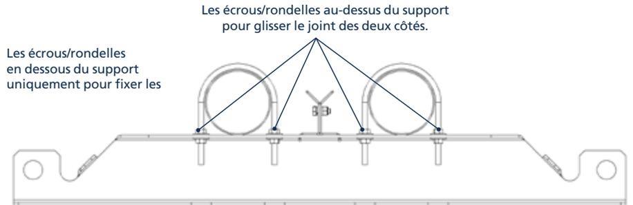
15-25kW modèles crochets restants M6 Boulons en U et les modèles 35-50kW tous les supports d'étriers filetés M8.
