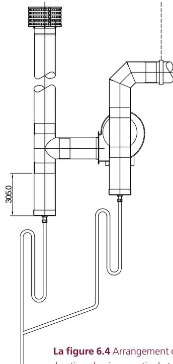
La figure 6.4 Arrangement de combustion classique sortie de toit
