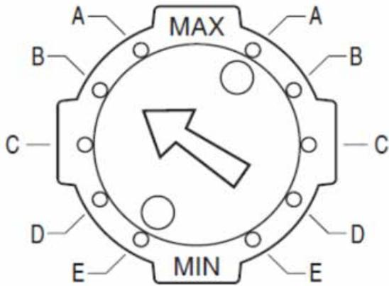
La figure 58. Honeywell VK4105C de la valve à gaz (gaz de réglage d'ouverture lente)
