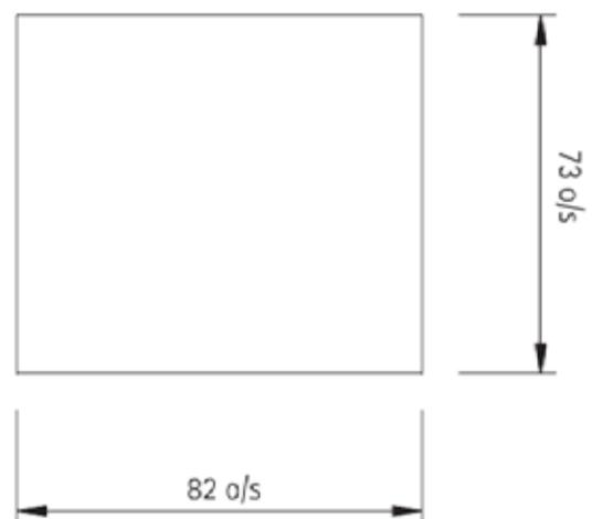
La figure 6.3 Dimensions de sortie du ventilateur de type 2
