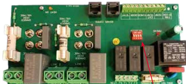
**Figure 23 Position du commutateur DIP**
