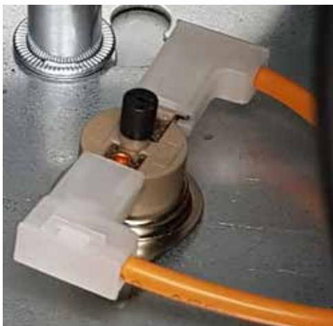
Figure 31 Coupe-circuit thermique
