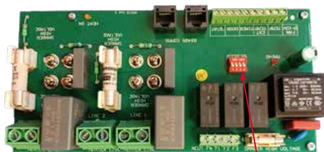
Figura 23 Posición del interruptor DIP
