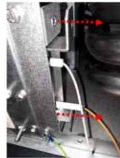
Verwijder de sondebevestigingsbeugel uit de kamer
