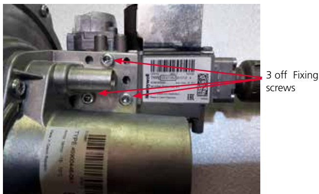
Vis de fixation de la valve à gaz PREEVA Neos 10-70
