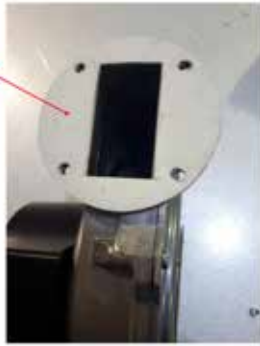
Joint de la bride de sortie du ventilateur
