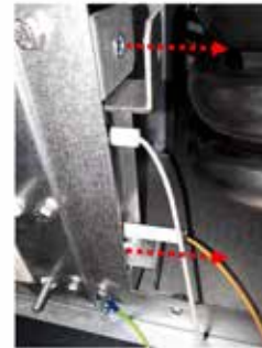
Sondenhalterung aus der Kammer herausziehen
