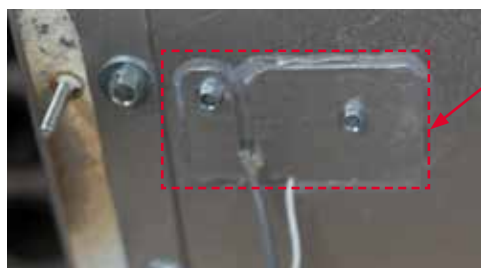
Silikondichtmittel um die Halterung
